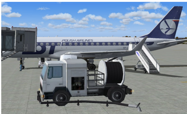
Tankování paliva z potrubního rozvodu pod plochou do letadla. Foto AES.
